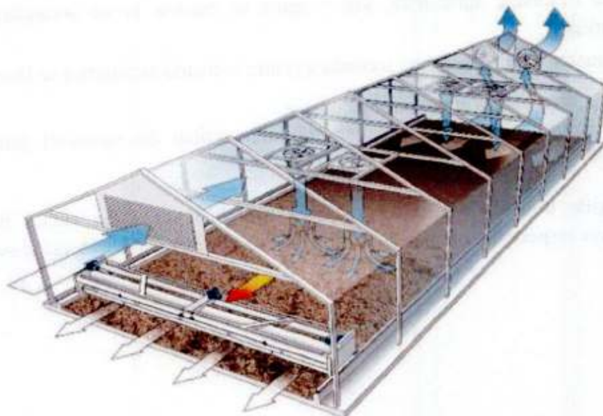
Figura 25 – Vedere de ansamblu stație solara de uscare cu evidentierea sistemului de ventilare
