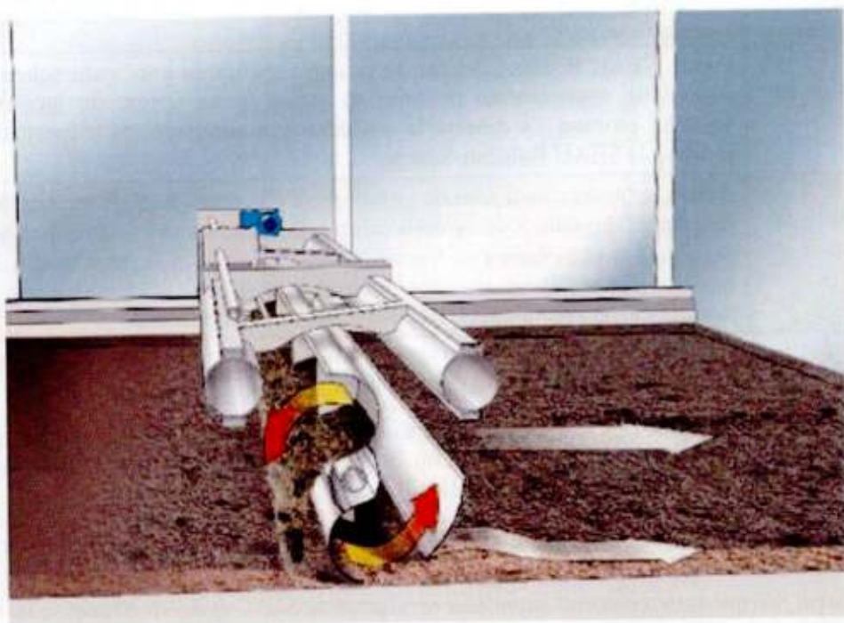
Figura 24 – Pod rulant de imprastiere, intoarcere, mixare si transport a namolului
